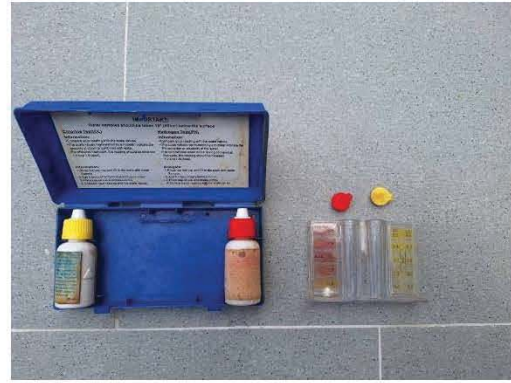
อุปกรณ์การตรวจวัดค่า pH และ Chlorine
